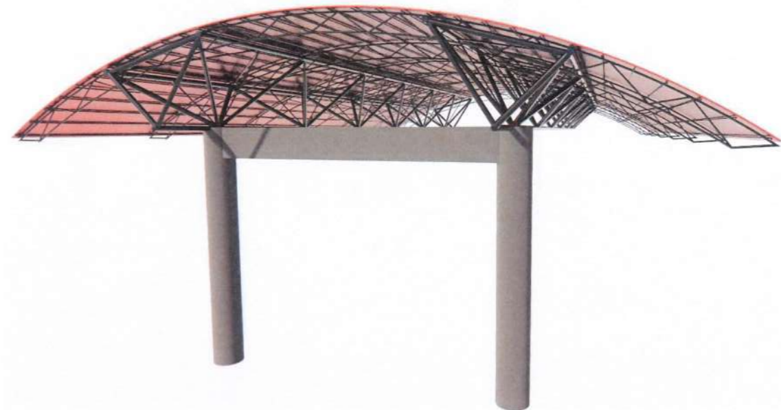
PORTE COCHERE TRUSSES
